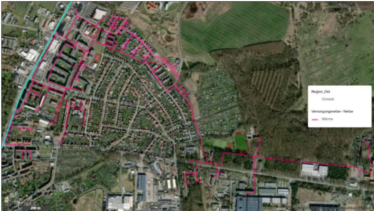
Abbildung 57: Wärmenetz Güstrow Nord - Gebiet Ost
