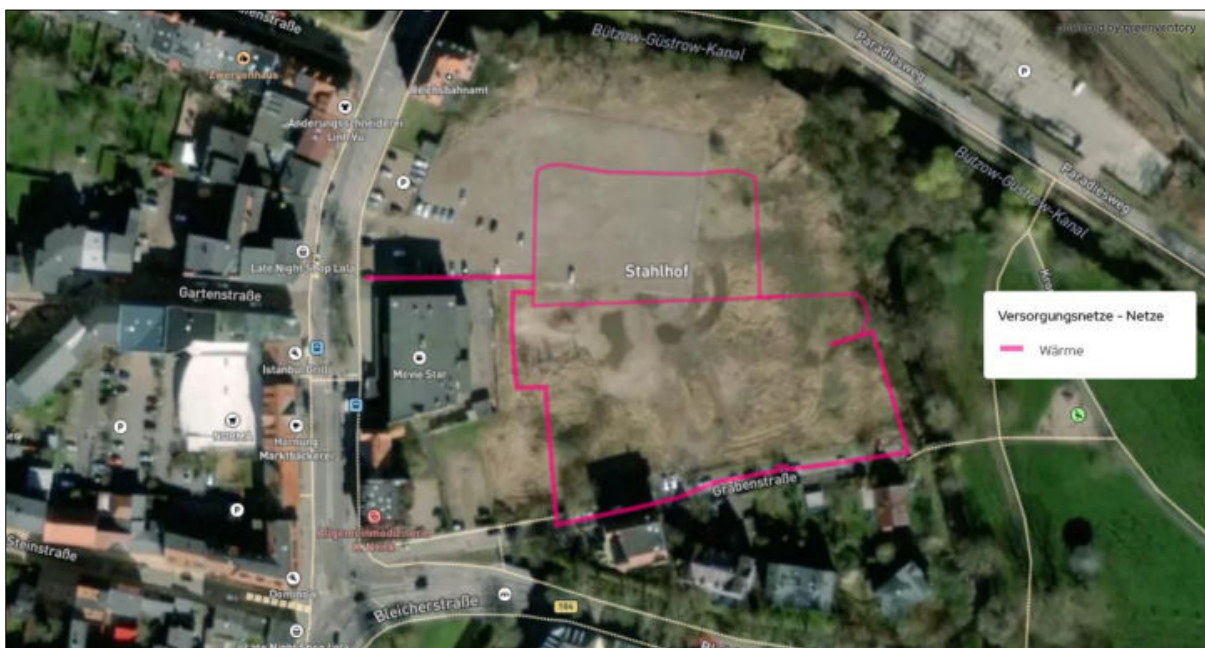
Abbildung 99: Wärmenetz Stahlhof - Gebiet West
