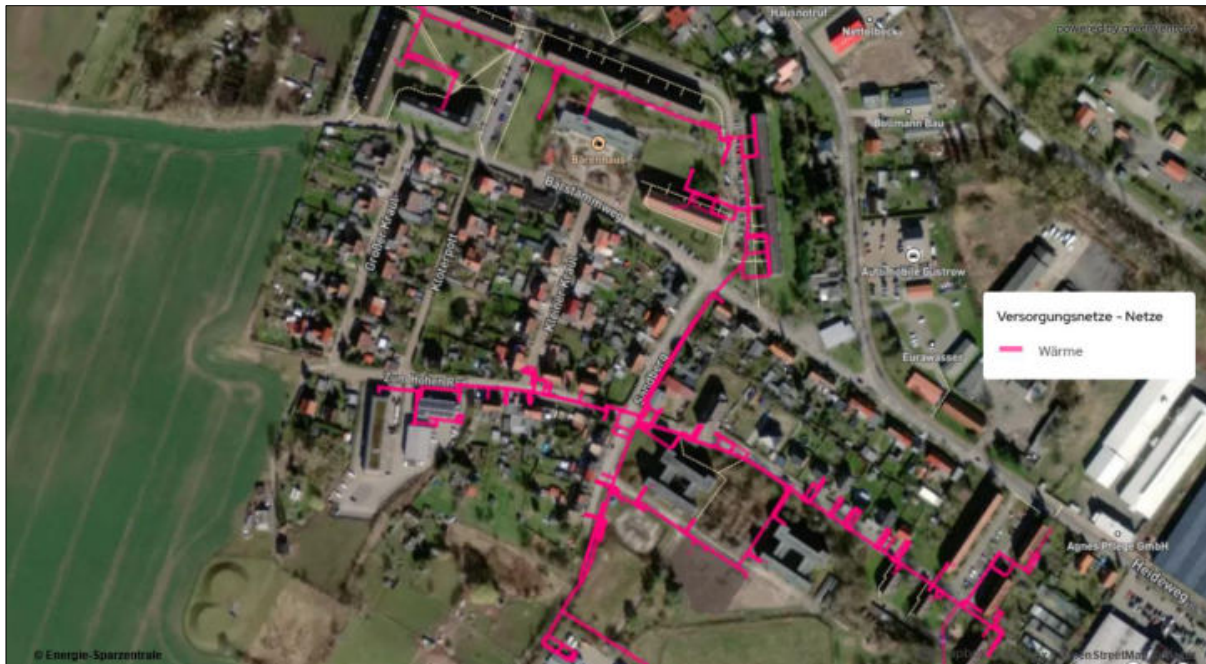
Abbildung 96: Wärmenetz HKW West - Gebiet West
